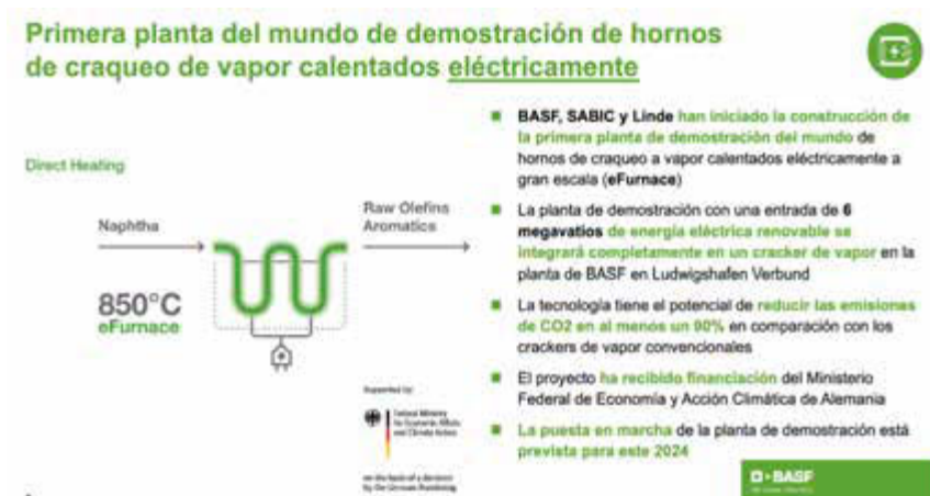
Figura 2.8 Demostración de hornos de craqueo de vapor calentados eléctricamente
